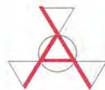
Das Bauhüttenzeichen besteht aus sechs gleich langen Strecken, die sich nach den Gesetzen der Triangulatur zu einem Symbol fügen.
