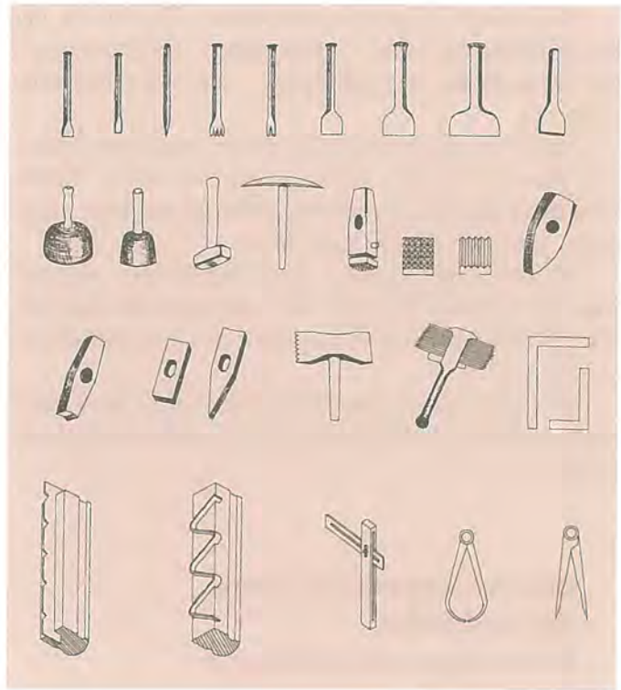
Abb. 12: Übersicht der manuellen Steinmetzwerkzeuge.
