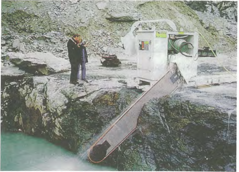
Abb. 11: Steinbruch Fa. Kogler; St. Urban/Sattendorf: Abbau mit Schwertsäge.
